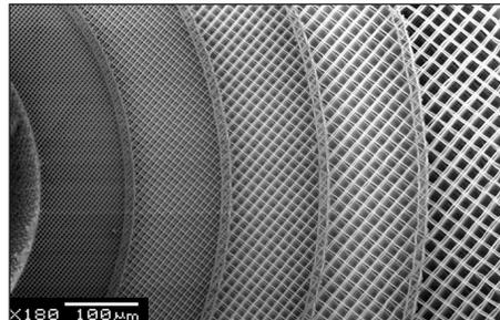
**SPHERICAL GRADIENT DENSITY FOAM**
